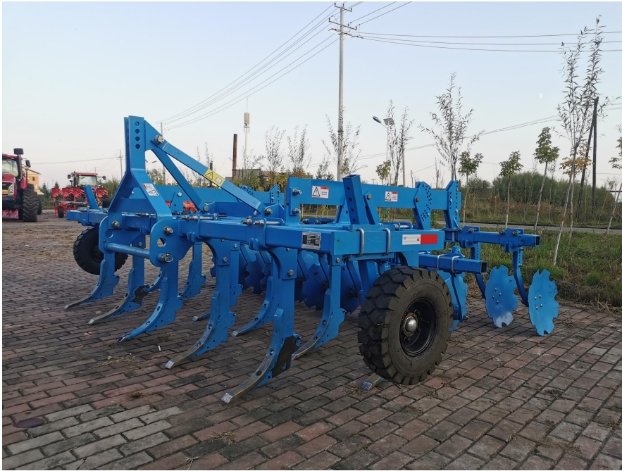
1SB-350 型复式少免耕深松耙地机
