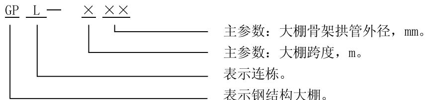
标记示例：跨度 6m，骨架拱杆外径 25mm 的农用连栋钢架大棚，表示为：GPL-625。
